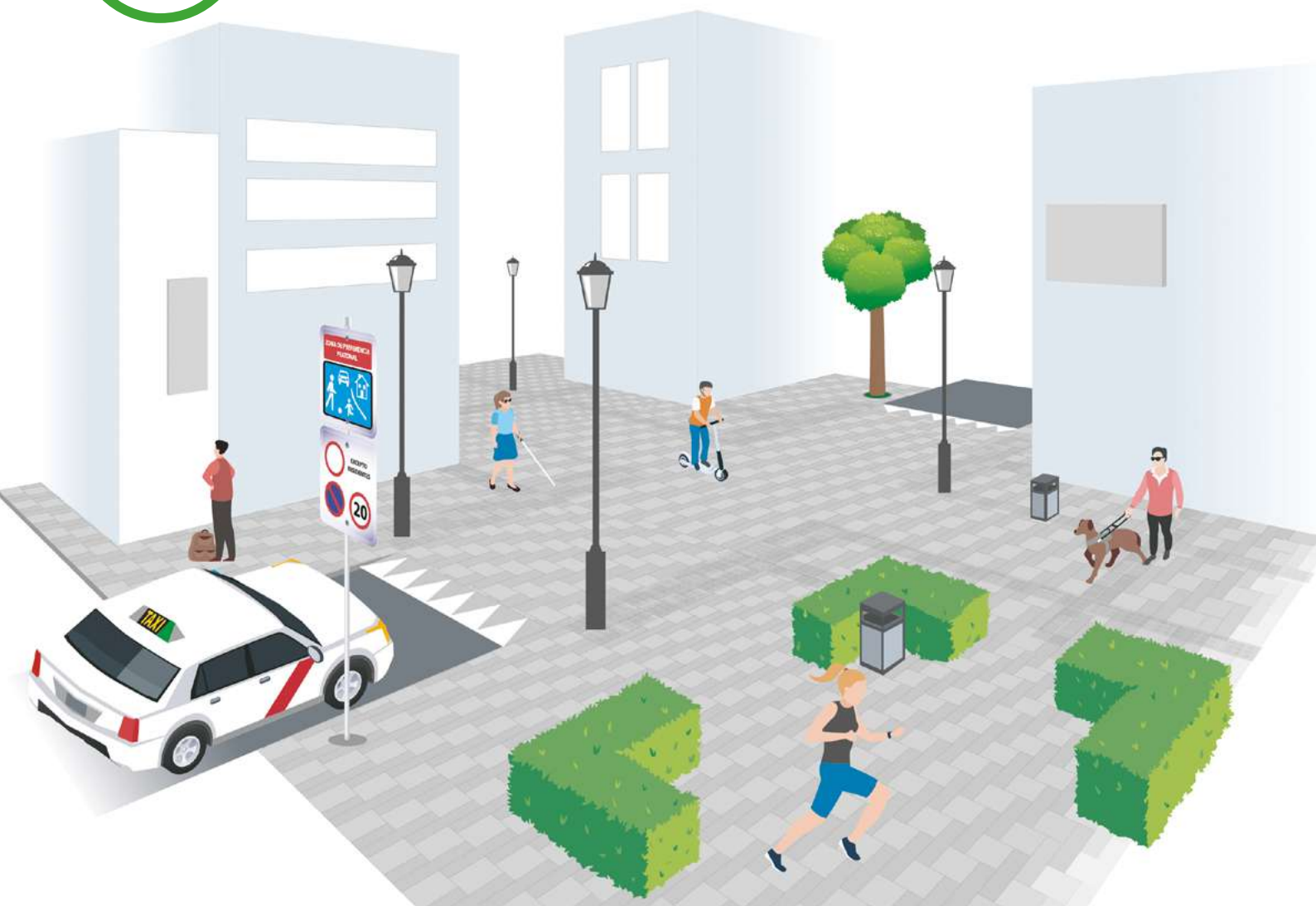
Imagen 22. Intersección de una plataforma única de tránsito compartido con otro tipo de vía.
