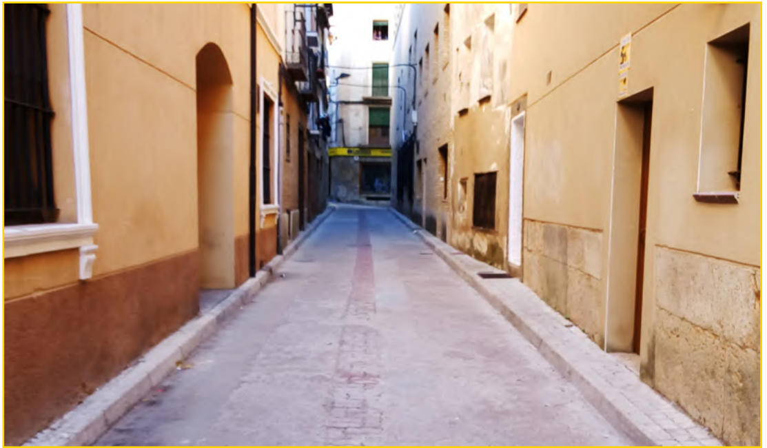
Imagen 1. Calle donde se justifica la implantación de una plataforma única por tener aceras estrechas e intransitables para los peatones.
