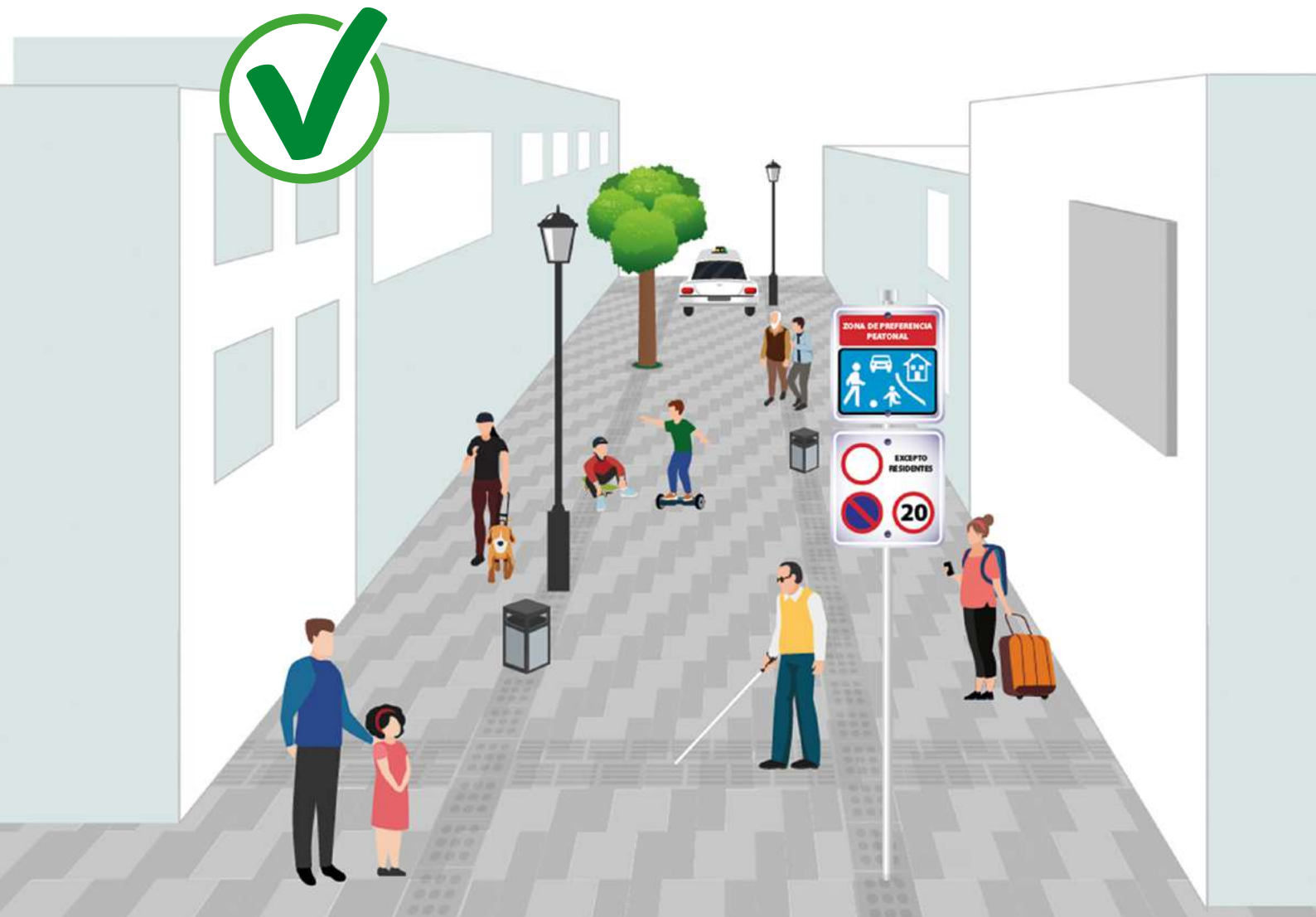
Imagen 20. Pavimento direccional que comunica ambas zonas de mayor seguridad.
